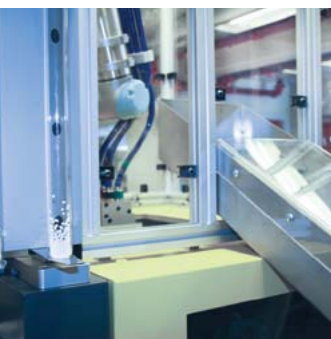
Робот прочно закреплен на машине для литья под давлением и способен перемещаться над литейной формой, извлекая пластмассовые детали. Эта операция совершается за счет специально сконструированной вакуумной системы, обеспечивающей предохранение хрупких деталей от повреждений.
